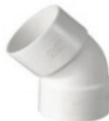
CODO 67,5° CANALETA H-H UNIÓN: CEMENTAR COLOR: BLANCO / MARRÓN MARCA: RESCO
