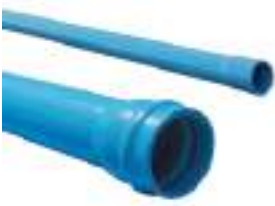
TUBO PVC PRESIÓN PN 6 NORMA CHILENA: NCH399 CERTIFICADOR: CESMEC COLOR: AZUL-CELESTE
