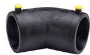
CODO 45° ELECTROFUSIÓN NORMA CHILENA: 398/2 Of. 2005 CERTIFICADOR: CESMEC UNIÓN: ELECTROFUSIÓN COLOR: NEGRO MARCA: ERA
